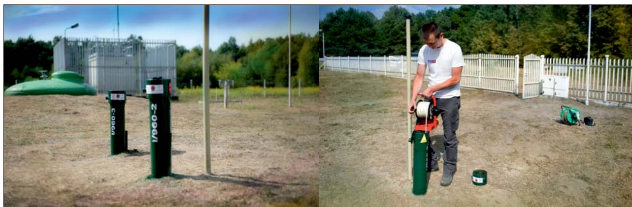
Ryc. 4. Stacja hydrogeologiczna I/960/1, I/960/2, Kampinoski Park Narodowy, wieś Granica, województwo mazowieckie. Badania hydrogeologiczne: pomiary stanu zwierciadła wód i wykonywanie oznaczeń terenowych parametrów fizyczno-chemicznych próbki wody (pomiary wykonuje Jacek Kochanowski). Materiały archiwalne PIG-PIB
