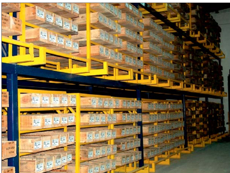
Ryc. 7. Magazyn w Halinowie. Skrzynek z rdzeniami wiertniczymi oznakowane etykietami z kodem kreskowym. Fot. M. Graniczny
