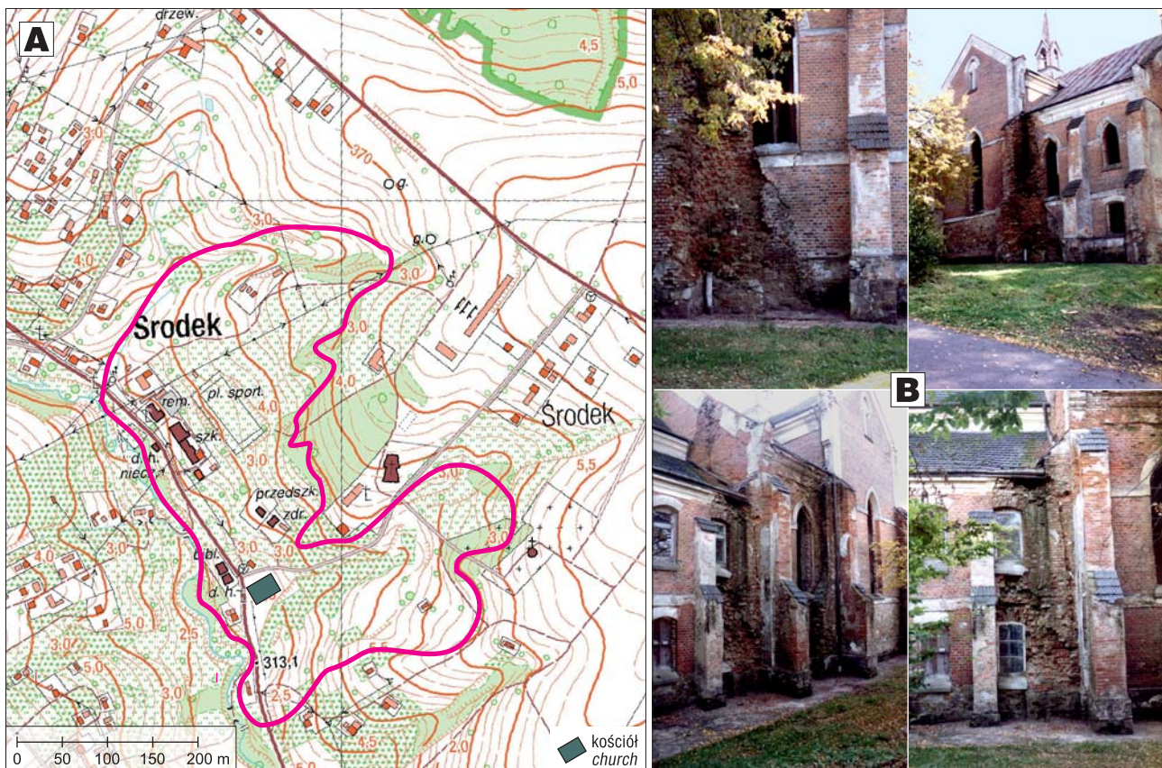
Ryc. 6. Osuwisko i kościół w Husowie: A – mapa osuwiska B – kościół; zdjęcia z 2001 r. Fig. 6. Landslide and church in Husów: A – map of landslide B – church; photos in 2001
