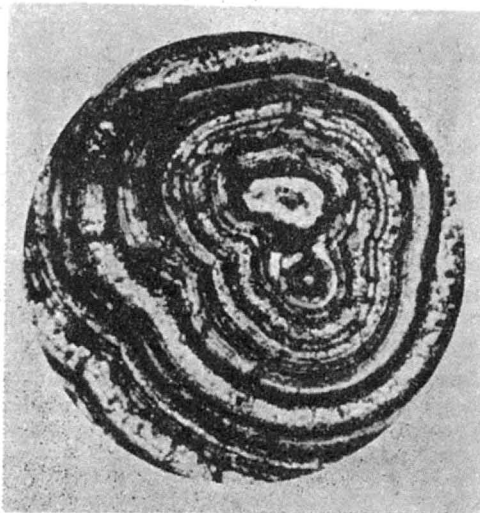
Ryc. 5 — Kolomorficzna struktura hydrohematytu. Gołaczów-Dańczów. Światło odbite z analizatorem. Pow. ok. 70 X
