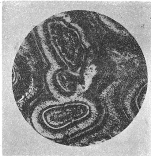
Ryc. 4 — Koncentryczno-zonalna budowa hydrohematytu. Stanisławów. Światło odbite, bez analizatora. Pow. ok. 18 X
