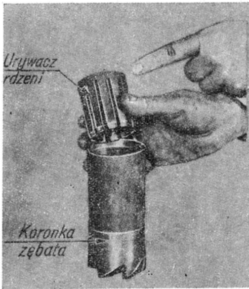
Ryc. 3. Wkładanie urywacza rdzeni do koronki
