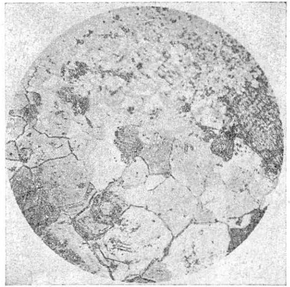
Fot. 11. Budowa powłokowa kwarcu paragenazy barytowo-kwarcowej. Nikole X. Powiększenie 36 X
