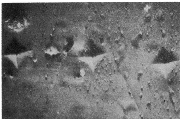
Ryc. 4. Odciski ostrza węgelnika diamentowego Vickersa w warstwie wierzchniej krzemienia, pow. 1000 X.
