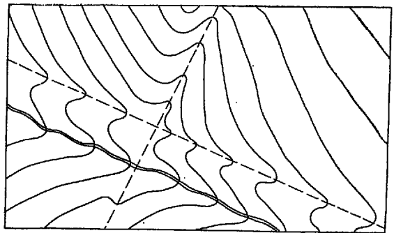
Ryc. 2. Typowy układ hydroizohips w utworach szczelinowych górnej kredy na Wyżynie Lubelskiej. Fig. 2. Type arrangements of hydroisohyps in fissure formations of the Upper Cretaceous in the Lublin Upland area.
