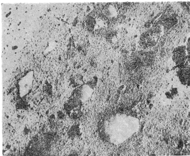
Ryc. 5. Makrofotografia zglądu ceramiki siwej, chropowatej, wytoczonej na kole garncarskim (Igołomia pow. Kraków — okres rzymski). Pow. 100 X.
