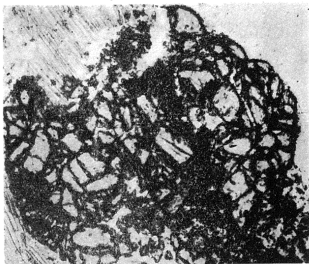
Ryc. 5. Almandyn manganowy występujący w rdzenio- wej części pegmatytu granitowego. Widoczny alma- dyn (silny relief), łuskowy muskowit i skalenie. Kop. „Wiry”, poz. III, chodnik 12 WB. Światło przechodzą- ce, bez nikoli, pow. 45 X.
