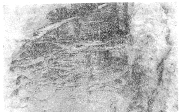
Ryc. 5. Sylifikacja wzdłuż nieregularnych powierzchni spękań w obrębie piasków szklarskich. Kopalnia piasków szklarskich na W od Osiecznicy.
