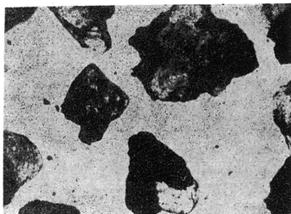
Ryc. 6. Piasek Zębiec. Odpad z separatora magnetycznego pracującego przy 18 kGs (10 A), pow. 20 X.
