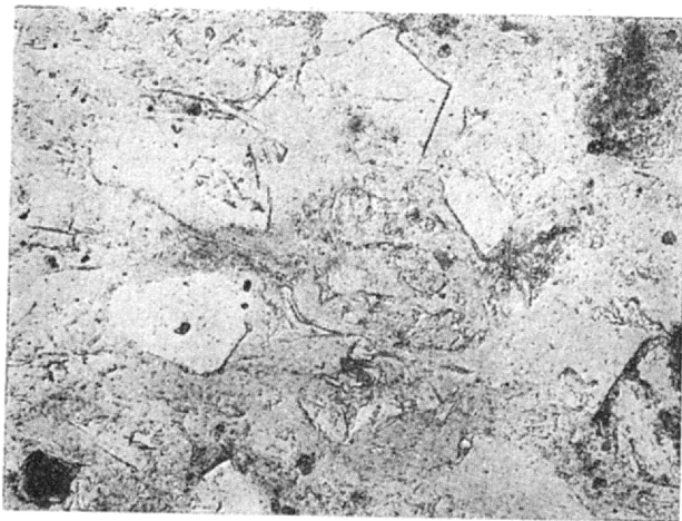
Ryc. 2. Fragment bentonitu z wiórkowatymi piroklastami kwarcu. Krzywopłoty P-8, głęb. 877,2 m, przy jednym polaroidzie, pow. 100 X.
