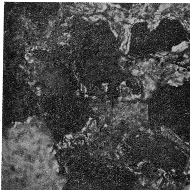
Ryc. 4. Piaskowiec drobnoziarnisty zawierający podwyższone ilości kalcytu. Obserwuje się ziarna kwarcu o powierzchniach nadtrawionych przez kalcyt. Prabuty IG-1, głębokość 3480,0 m, pow. 200X, płytka cienka, nikole skrzyżowane.
