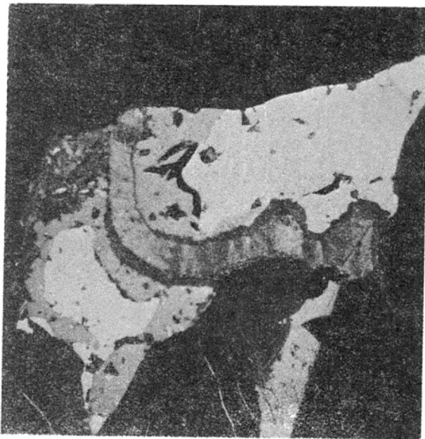
Ryc. 3. Żyłka grafitowa otoczona wtórnym magnetytem powstającym z pirotynu. Pow. 250 X.
