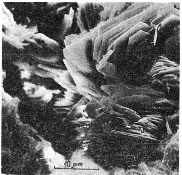
Ryc. 8. Obraz mikrostrukturalny dolomitu typu D 3 . Fig. 8. Microstructural image of dolomite of the type D 3 .
