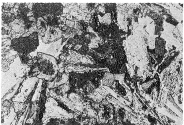
Ryc. 6. Dedolomityzacja dolomitu — pojedyncze ziarna z pyłem podolomitowym w tle anhydrytowym; pow. \times 70 , nikole skrzyżowane.
