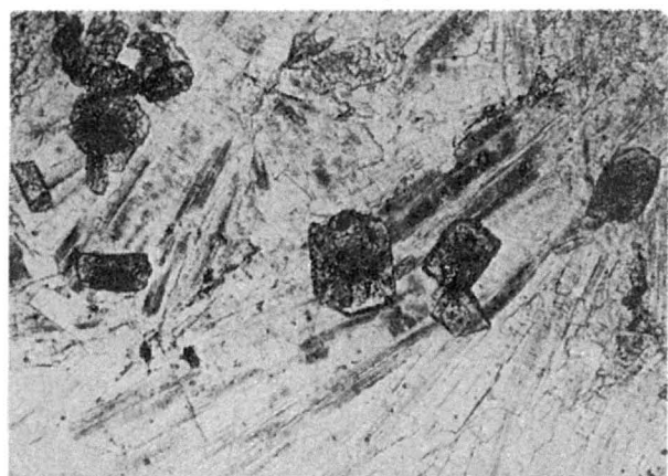
Ryc. 5. Dedolomityzacja dolomitu — widoczne ziarna wtórnego kalcytu z pyłem podolomitowym na całej powierzchni ziarn; pow. \times 70 , światło zwyczajne.
