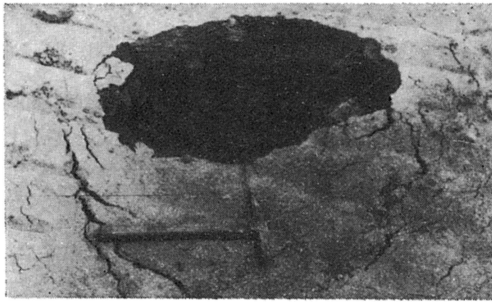
Ryc. 12. Zapadliska powierzchniowe na poziomie roboczym zwałowiska pątnowskiego.
