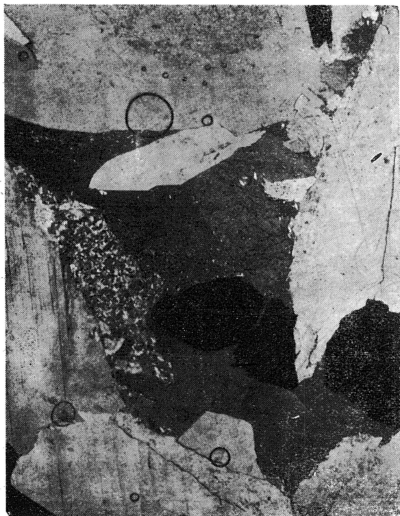
Gips gruboziarnisty, szlif nr. 7/2; jasne — kryształy gipsu, ciemne — węglan wapnia. Nikole skrzyżowane Fot. A. Teofilak
