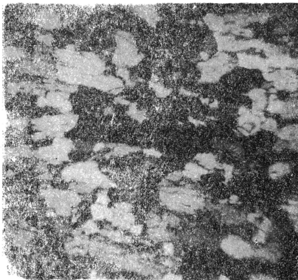
Ryc. 2. Mikrografia łupku kwarcytowego z Jęglowej. Struktura drobnoziarnista, tekstura kierunkowa. Widoczne liczne wrostki. (pow. 80 X, nikole skrzyż.).
