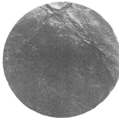
Ryc. 8. Piaskowiec z serii szarej. Widoczne dobrze zachowane pory pomiędzy ziarnami detrytycznymi i niewielkie gniazdzowe skupienia kaolinitu nieznacznie redukujące przestrzeń porową skały; Czarne 2, głęb. 3819,7 m; \times 66
