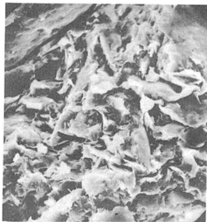
Ryc. 12. Szczeliny wysychania osadu. Czarne 2, głęb. 3835,3 m; \times 0,66
