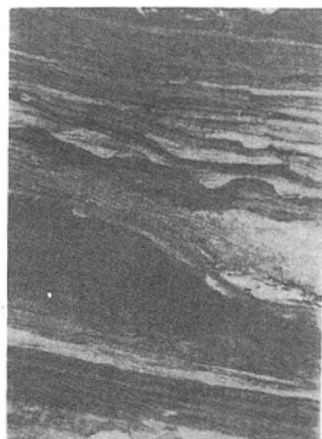
Ryc. 5. Mułowiec z anhydrytem, laminowany drobnoziarnistym piaskowcem. Widoczne rozmoczenia erozyjne lamin; Czarne 5, głęb. 3811,8 m; \times 0,66
