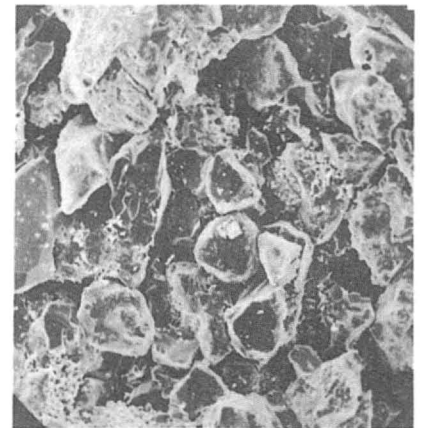
Ryc. 9. Piaskowiec z serii brunatnej. Przestrzeń porowa w całości wypełniona zwartą masą ilasto-węglanowo-anhydrytową; Czarne 5, głęb. 3787,3 m; \times 132
