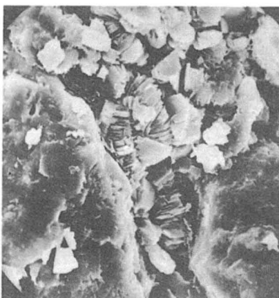
Ryc. 11. Drobnopłytkowy illit zabudowuje w całości przestrzeń międzyziarnową; Czarne 4, głęb. 3861,7 m; \times 660
