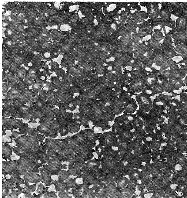
Ryc. 12. Dolomit płytowy — oolit. Formy regularne o dobrej selekcji. Otwór Ustronie Morskie IG1, głęb. 2476,3; płytka cienka, pow. 7 ×.
