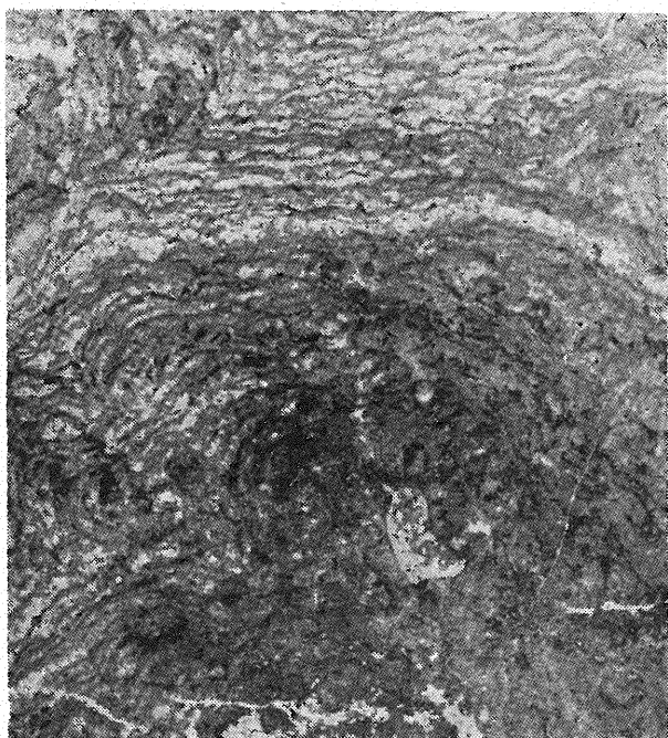
Ryc. 4. Wapień cechsztyński. Biolityt glonowo-otwornicowy. Półkuliste laminy glonowe obrosnięte są rurkowatymi otwornicami sesylnymi. Biolityt silnie impregnowany anhydrytem. Otwór Grzybnica IG1, głęb. 2533,6; płytka cienka, pow. 7x.
