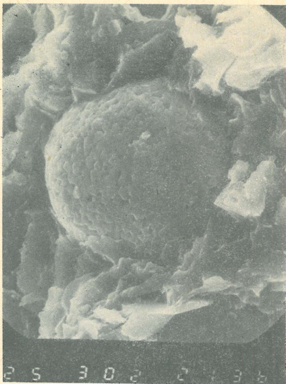
Rys. 4. Iłowce o zwartej budowie z mikro- i ultraporami. Zdjęcie wykonane mikroskopem elektronowym JXA-35, pow. 3000 X.
