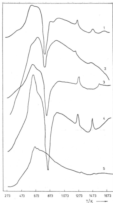
Ryc. 2. Krzywe termoróżnicowe (DTA) badanych próbek.
