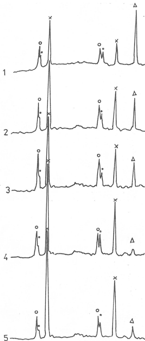
Ryc. 4. Dyfraktogramy produktów rozdziatu sedymentacyjnego.
