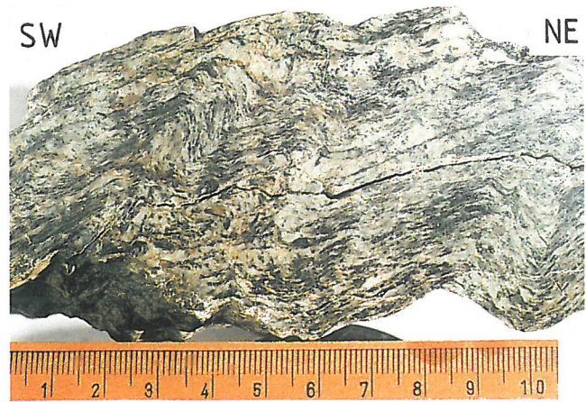
Fig. 9. Przykład fałdów otwartych asymetrycznych F_{1b} . Zauważ asymetryczne porfiroklasty typu \sigma na długich skrzydłach fałdów. Łupki łuszczykowe. Jednostka Niedamirowa. Płaszczyzna XZ elipsoidy odkształcenia całkowitego. Skala w cm
