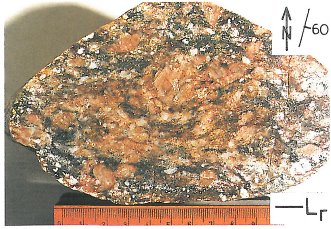
Ryc. 8. Lineacja z rozciągania L_{r2} na powierzchni foliacji S_2 . Ortognejs kowarki. Skala w cm
