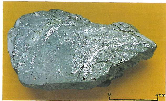
Ryc. 7. Gniazdowa mineralizacja löllingitowo-arsenopirytowa (lö-as) w postaci koncentryczno-promienistej o zawartości złota drobnodispersyjnego powyżej 8 g/t. Próbką k 6/1 klm Złoty Jar. Skala diopsydowo-tremolitowo-kalcytowo-talkowa Fig. 7. Nest like löllingite-arsenopyrite (lö-as) mineralization in concentric-radial form with content of invisible gold over 8 g/t. Sample k 6/1 — diopside-tremolite-calcite-talc rock. The Złoty Jar quarry near Złoty Stok
