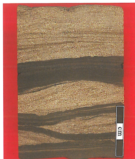
Ryc. 5. Warstwowanie soczewkowe (dolna część fotografii); w górze fragment grubszej, piaszczystej warstwy heterolitu o warstwowaniu falistym, z widocznymi śladami wewnętrznych struktur riplemarków falowych. Wiercenie Ignacy 2, gł. 886,4 m
