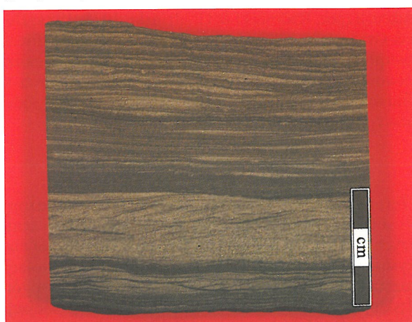
Ryc. 6. Mułowiec o laminacji falistej, z licznymi, wydłużonymi soczewkami grubszego materiału (górna część fotografii) i heterolit (dolna część fotografii). Wiercenie Gołkowice 13, gł. 1339 m
