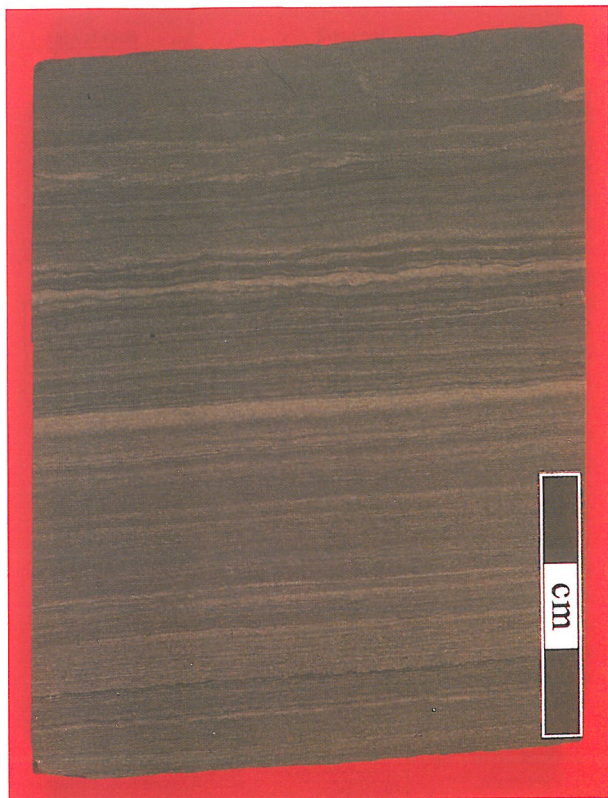
Ryc. 9. Mułowiec o charakterystycznie rytmicznej, generalnie płaskiej laminacji. Wiercenie Ignacy 2, gł. 993 m Fig. 9. Mudstone showing rhythmic horizontal lamination. Borehole Ignacy 2, depth 993 m
