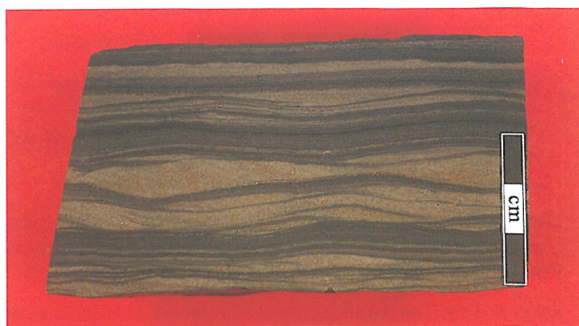
Ryc. 4. Heterolit o warstwowaniu falistym. Wiercenie Moszczenica 16, gł. 1068 m
