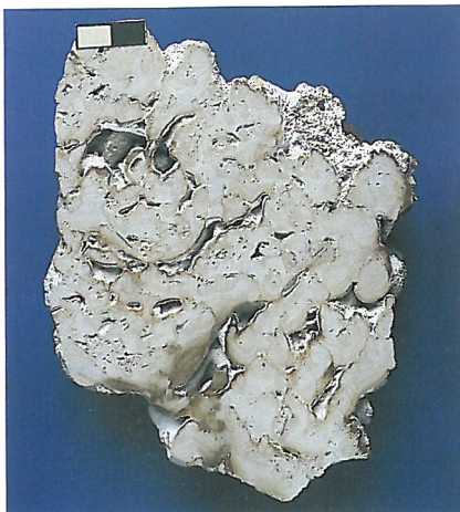
Ryc. 4. Bandston serpulowo-mikrobialitowy, różne odmiany: A (górna) — bardzo duża pierwotna porowatość wzrostowa wypełniona jest dwiema generacjami osadów wewnętrznych. Małe okrągłe „dziurki” to przekroje rurek serpul, Łysaków. B (dolna) — na rurkach serpulach narastają małe kolumnienki stromatolitowe; przestrzeń między kolumnienkami wypełnia laminowany geopetalny osad wewnętrzny, Wierzchowiska. C (prawa) — pierwotne kawerny wzrostowe wypełnione są cementami synsedymentacyjnymi (ciemnobrązowe obwódki) i osadami wewnętrznymi (białe), Łysaków; skala 2 cm; fot. 4–6 J. Modrzejewska
