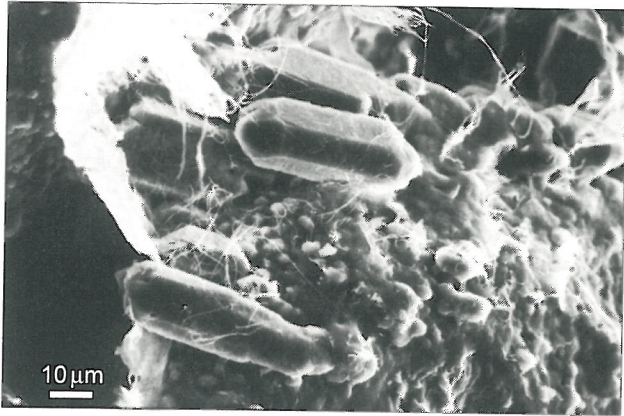
Ryc. 11. Cement kwarcowy w piaskowcu (obraz z SEM), złożony z licznych bardzo drobnokrystalicznych osobników anhedralnych i większych kryształów euhedralnych o pokroju słupa heksagonalnego z podwójną piramidą
