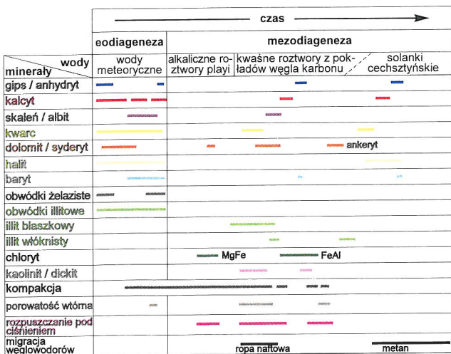
Ryc. 31. Sekwencja diagenetyczna osadów czerwonego spągowca z północnych Niemiec (Gaupp i in., 1993, nieco zmienione)
