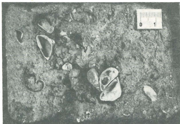
Ryc. 4. Przekrój próbki jeziornych osadów ilasto-organicznych z zachowanymi muszlami mięczaków.
