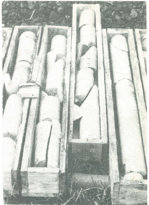
Ryc. 5. Spękania w piaskowcu obserwowane na rdzeniach wiertniczych z otworu L-94
