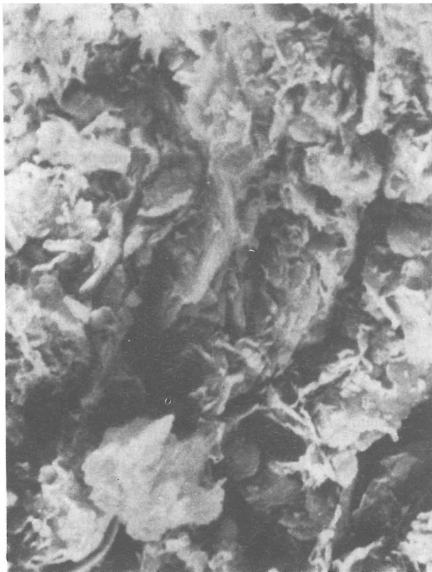
Ryc. 5. Zdjęcia dwóch powierzchni przelamu iltu z Machowa (SEM, pow. 3000×).
