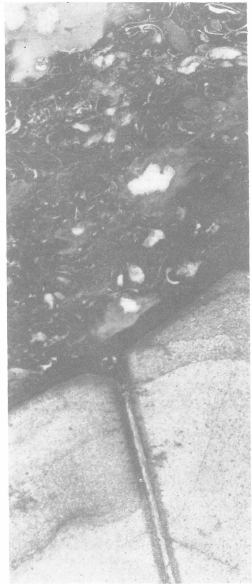
Ryc. 5. Dyskordancja sylur (ludlow)—dewon (żywet). Na sfałdowanych piaskowcach fliszowych syluru leży bioturbidyt muszlowy i wyżej dolomity żywetu. Sylurskie piaskowce są przecięte żyłą pirytu, która na powierzchni nieciągłości przechodzi w osady źródeł gorących. Zawiercie, otwór ZL8—10, głębokość 152,2 m, grubość rdzenia 65 mm.
