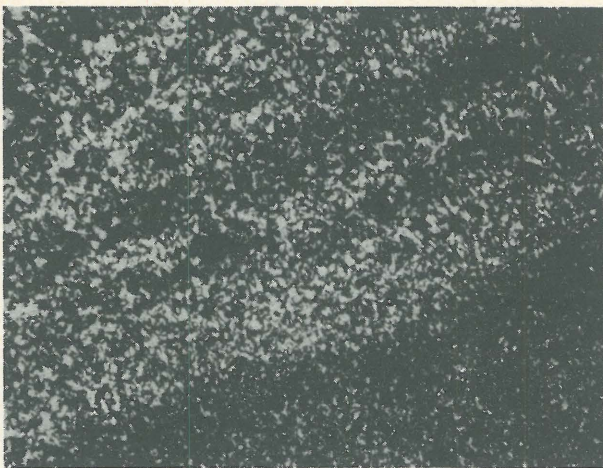
Ryc. 1. Chalcedon o mikrostrukturze pseudoziarnistej, mozaikowej. Agat jasnopielaty o niewyraźnym, subtelnym rysunku, słabo przeświecający na krawędziach (próbka nr 6). Nikole niezupełnie prostopadłe, pow. 40 ×
