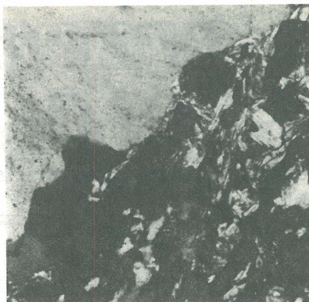
Ryc. 2. Kontakt skały kwarcowej z otaczającymi łupkami łyszczykowymi: odsłonięcie na górze Skalnik (złożę w Olesznej Podgórskiej), pow. 160×.
