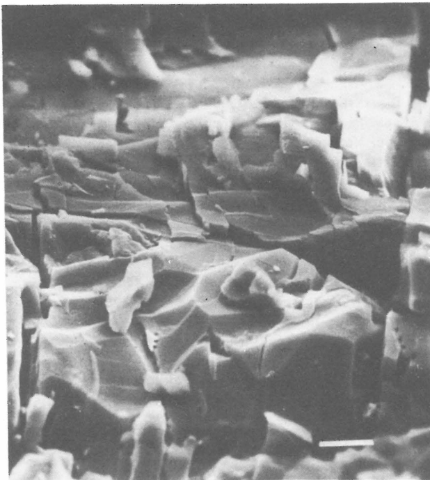
Ryc. 1. Spękania w meteorycie Ness County 1894 (skala 10 \mu\text{m} )
