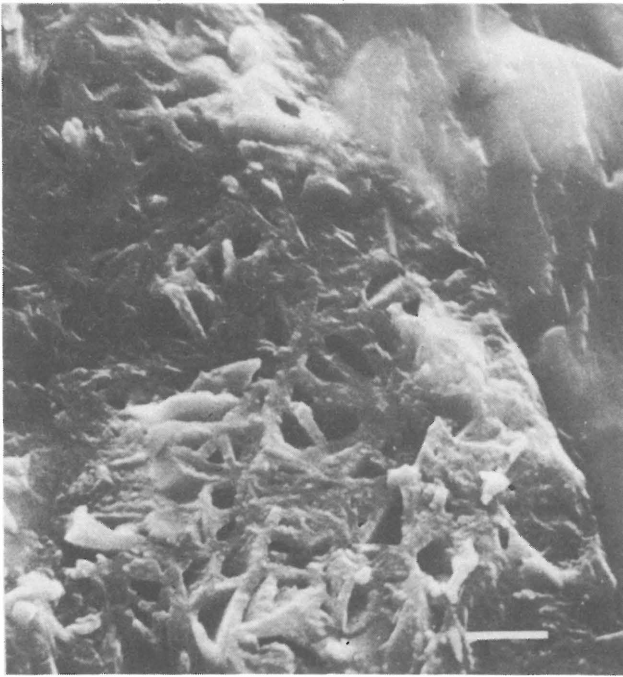
Ryc. 3. Pory międzykrystaliczne w meteorycie Ness County 1894 (skala 2 \mu\text{m} )
