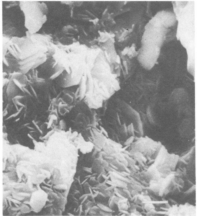
Ryc. 4. Pory międzyziarnowe w meteorycie Krymka (skala 2 \mu\text{m} )
