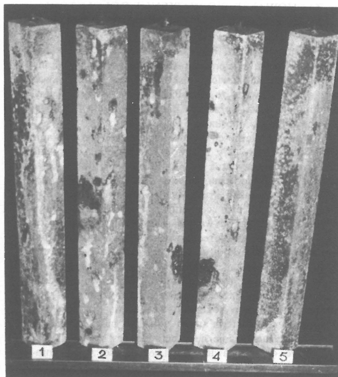
Ryc. 6. Powierzchnie beleczek betonowych z kruszywem ze złóż Halinów (1, 2), Żabiny (3), Rydwan (4, 5) oraz z cementami portlandzkimi „350” Nowiny II (1, 3, 5) i Saturn (2, 4). Pow. 2×.
