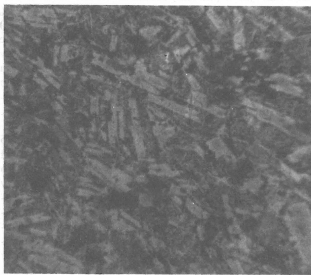
Ryc. 5. Diabaz całkowicie przeobrażony na kontakcie ze skałami otaczającymi. Mikrofotografia w świetle przechodzącym; 1 nikol, pow. 52 x.
