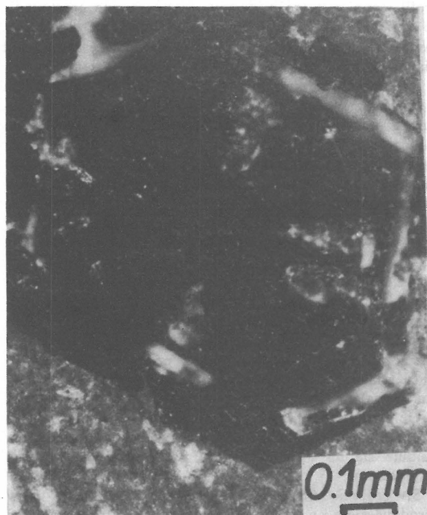
Ryc. 7. Przekrój kryształu galeny o budowie szkieletowej. Mikroskop optyczny, światło odbite, nikole x.
