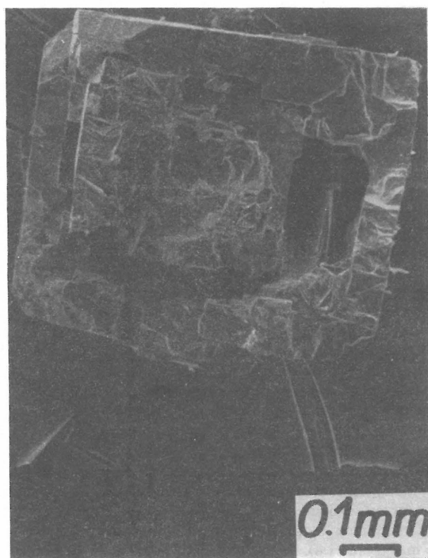
Ryc. 3. Kostkowy kryształ galeny o budowie szkieletowej. SEM Fig. 3. Cubic galena crystal with skeletal structure. SEM
