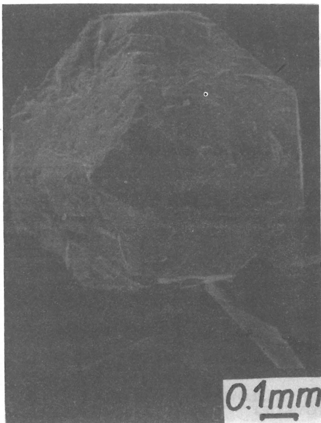
Ryc. 1. Kryształ galeny z przewagą {111}. SEM Fig. 1. Galena crystal with predominance of {111}. SEM
