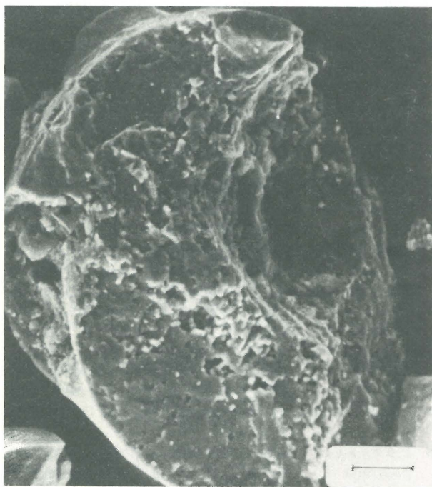
Ryc. 11. Fragment ziarna o porowatej strukturze (linia skali 20 \mu\text{m} ).
