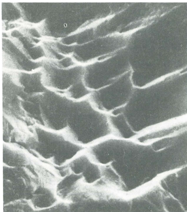
Ryc. 9. Głębokość 75,4–76,0 m, pow. 5000×. Ukierunkowane formy prawdopodobnie wytrawień chemicznych (rozpuszczania).
