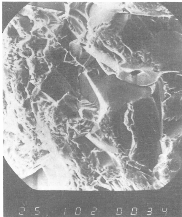
Ryc. 13. Głębokość 10,5–11,0 m, pow. 1000×. Świeże formy przełamów, nakładających się na siebie.
