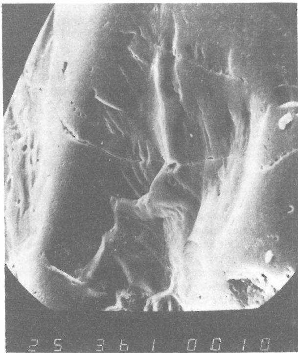
Ryc. 14. Głębokość 6,2–7,5 m, pow. 360×. Prawie gładka powierzchnia ziarna obtoczonego. Widoczne początkowe spękania i drobne odpryski v-kształtne.
