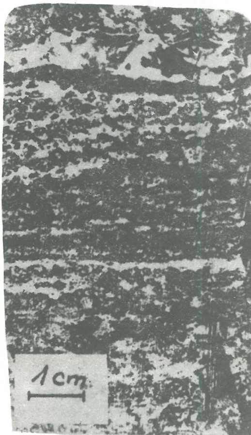
Ryc. 10. Wapień asfaltonośny o teksturze wstęgowej. Siarka zastąpiona przez asfalt. Mishraq.
