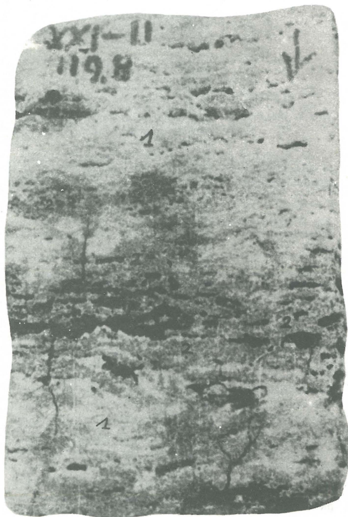
Ryc. 9. Wapień siarkonośny o teksturze wstęgowej całkowicie zrekrystalizowany (1), kawerny wypełnione asfaltem (czarny) w ich sąsiedztwie siarka usunięta (2 – jasnoszare „aureole” wokół kawern z asfaltem). Mishraq 1/2 wielk. nat.
