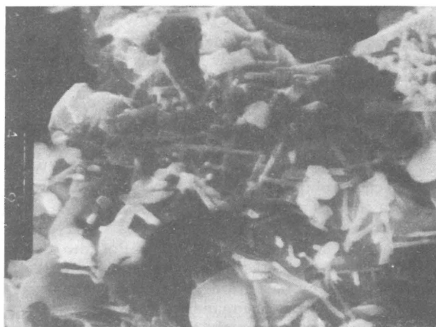
Ryc. 2. Fragment tworzywa ceramicznego otrzymanego z wypalania łożupku LZW w temp. 1150°C. Na całej powierzchni widoczne różnie zorientowane, gęsto upakowane i dobrze wykształcone kryształy mullitu wtórnego. Powiększenie 450×
