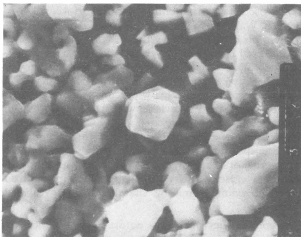
Ryc. 3. Fragment tworzywa zawierającego skupienia romboedrycznych ziarn ferrokordierytu. Powiększenie 9000×
