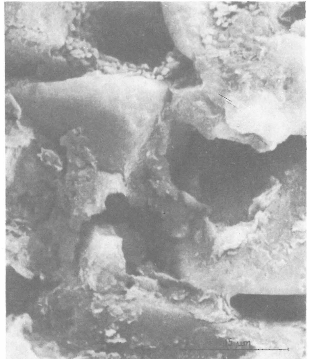
Ryc. 5. Łańcuszki ilaste i podpory ilaste
