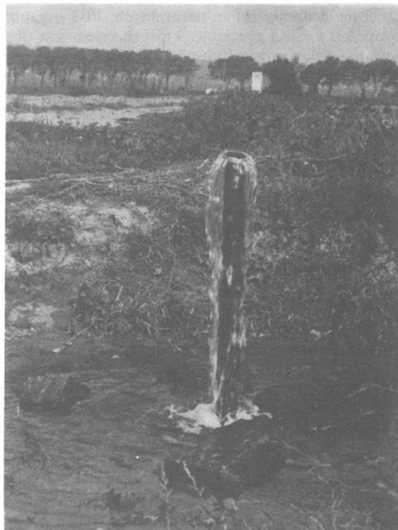
Ryc. 2. Samowypływ z otworów fluwioglacjalnych w dolinie Wisły. Fot. J. Malinowski
