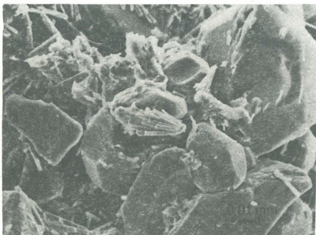
Ryc. 8. Skała gipsowa drobnokrystaliczna z pręcikowymi kryształami celestynu. Obraz ogólny dla ryc. 8. Litotyp h. Otw. Niwa 1, głęb. 61,6 m; SEM
