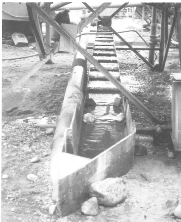
Ryc. 1. Wzbogacalnik strumieniowy prosty, zainstalowany w kopalni kruszywa Pilce
