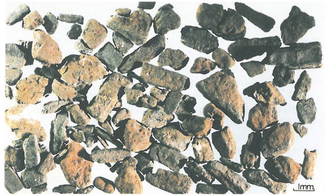
Ryc. 7. Odpady Pb (płytki i nieforemne ziarna, silnie przeobrażone), z próbki K-0204
