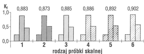
Ryc. 12. Rozkład przeciętnych wartości minimalnych, maksymalnych i średnich współczynnika formy porów. Objasnienia rodzaju próbki skalnej jak na ryc. 5
