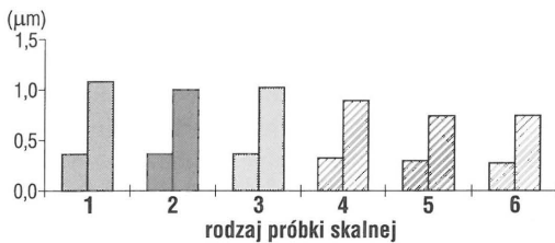
Ryc. 7. Rozkład przeciętnych minimalnych i średnich wartości średnic porów. Objasnienia rodzaju próbki skalnej jak na ryc. 5
