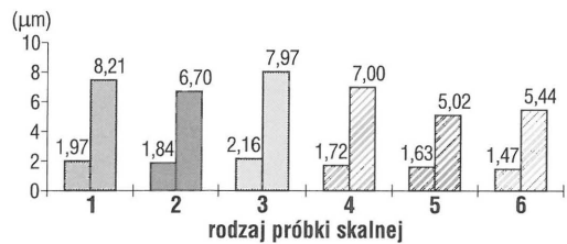
Ryc. 9. Rozkład przeciętnych minimalnych i średnich wartości obwodów porów. Objasnienia rodzaju próbki skalnej jak na ryc. 5
