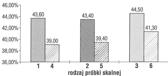
Ryc. 6. Rozkład średniej porowatości efektywnej kredy piszącej i opoki marglistej. Objasnienia rodzaju próbki skalnej jak na ryc. 5
